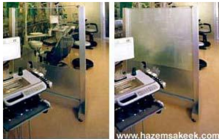
صورة رقم (٢٣) توضيح الزجاج الذكى ٣٢ صورة (٢٤) على اليسار لوح زجاجي شفاف من البلورات السائلة تحول إلى لوح معتم في الصورة على اليمين ٣٣
